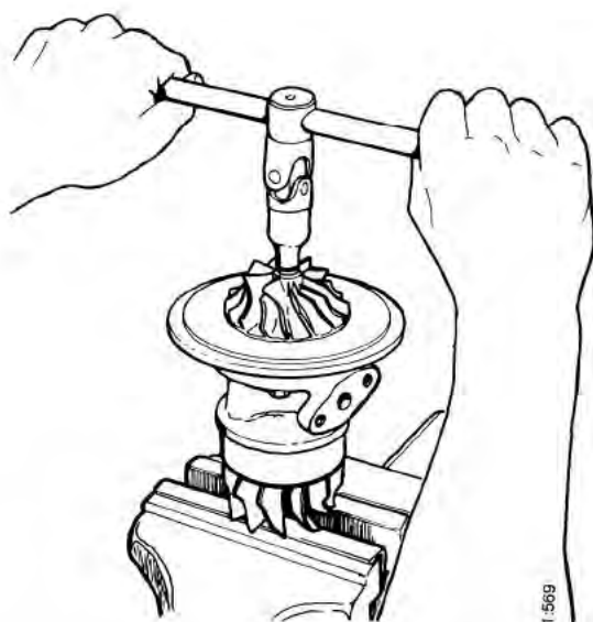
Fig 46. Muttern vid kompressorhjulet lossas
