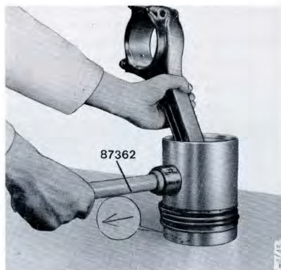
Fig 86. Ditsättning av kolv på vevstake
